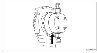
Fig. 37: Leakage hole
